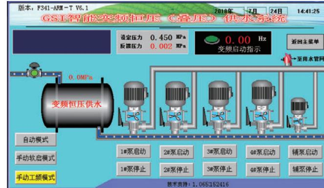
触控左下角的手动工频模式按钮，此按钮将变成黄底色，此时系统转成手动软启模式。每台水泵下面都有启动按钮及停止按钮。触控启动按钮相应水泵启动、触控停止按钮相应的水泵停止。(手工频模式说明：当按启动按钮时水泵以工频直接启动、按停止按钮时水泵停止)。
