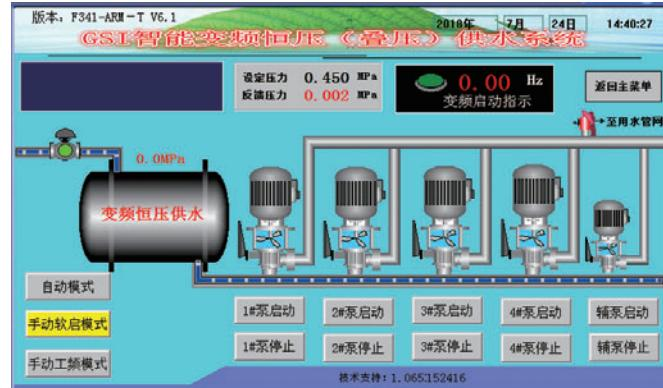
触控左下角的手动软启模式按钮，此按钮将变成黄底色，此时系统转成手动软启模式。每台水泵下面都有启动按钮及停止按钮。触控启动按钮相应水泵启动、触控停止按钮相应的水泵停止。(软启模式说明：水泵电机手动启动时先按用变频器按设定好的加减速时间启动水泵，等水泵变频运行到 50HZ 延时 2 秒切至工频回路工作。因为系统只有一台变频器，不能同时启动多台水泵，只有上一台启动完成并转至工频运行后才能启动下一台水)。
