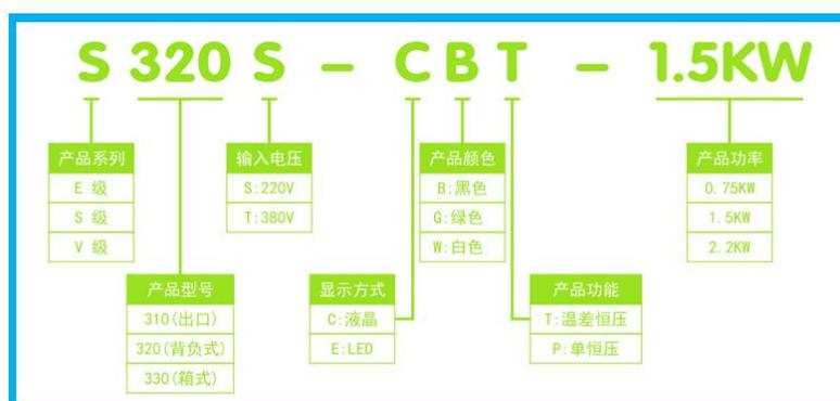
S320-E 型号为 S320S-EXX-XX/S320T-EXX-XX, 其中 S 表示单相 AC 220V 输入, T 表示三相 AC 380V 输入, 后缀 XX 代表功率。如 S320S-EXX-2.2KW 表示的是 S320-E 系列, 其输入电压为单相 220V, 额定功率为 2.2kW。
