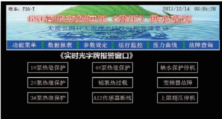
当有故障时对应的光字牌变成红色。有此故障消失后会自动启动系统以保证供水实时性，但有些故障是设备自身硬件故障需维修后按复位键复位。
