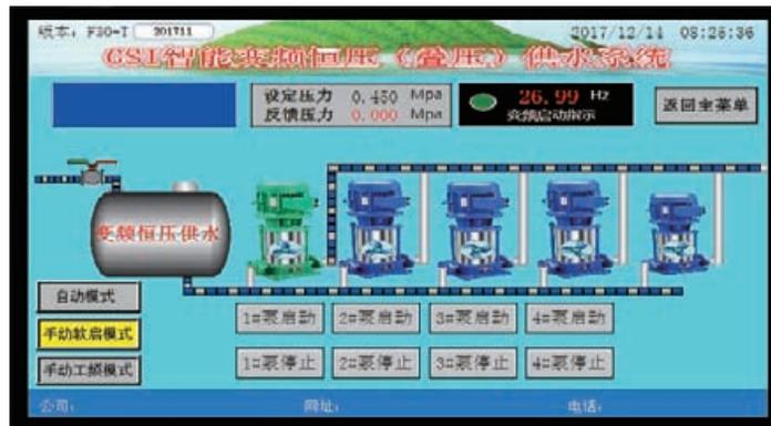
触控左下角的手动软启模式按钮，此按钮将变成黄底色，此时系统转成手动软启模式。每台水泵下面都有启动按钮及停止按钮。触控启动按钮相应水泵启动、触控停止按钮相应的水泵停止。（软启模式说明：水泵电机手动启动时先按变频器按设定好的加减速时间启动水泵，等水泵变频运行到 50HZ 延时 2 秒切至工频回路工作。因为系统只有一台变频器，不能同时启动多台水泵，只有上一台启动完成并转至工频运行后才能启动下一台水）。
