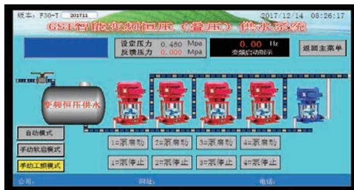
触控左下角的手动工频模式按钮，此按钮将变成黄底色，此时系统转成手动软启模式。每台水泵下面都有启动按钮及停止按钮。触控启动按钮相应水泵启动、触控停止按钮相应的水泵停止。（手动工频模式说明：当按启动按钮时水泵以工频直接启动、按停止按钮时水泵停止）。
