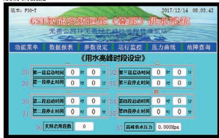
在各段输入启动时间及停止时间，并输入高峰供水压力，最后根据实际启用的段数输入实际启段数。若为段数为0则关闭此功能。
