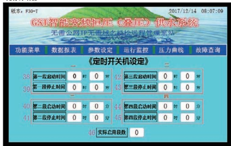
在各段输入启动时间及停止时间，最后根据实际启用的段数输入实际启段数。若为段数为0则关闭此功能。
